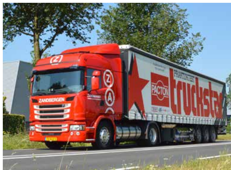
Een LNG-truck herken je aan de ronde RVS tanks. Scania en Iveco gebruiken hetzelfde merk.
