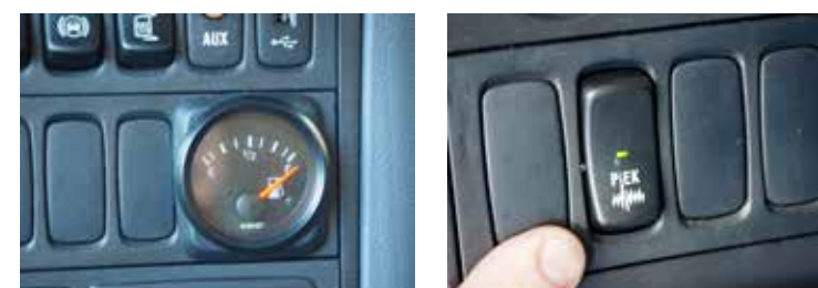
De Scania heeft een later ingebouwde brandstofmeter van VDO.
