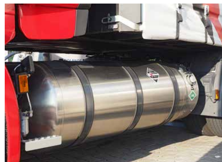
Geen tank maar een grote thermosfles.
