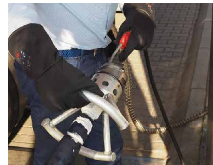
Het vulstuk moet goed drooggespoten worden met stikstof.
