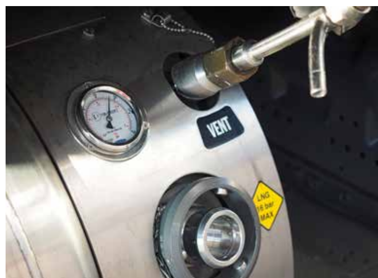
De manometer op de tank geeft aan hoe hoog de druk is.
