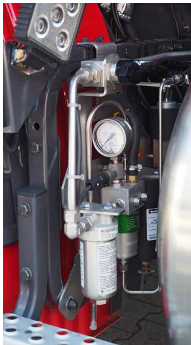
Het gaspaneel met de drukmeter, filters en afsluiters.
