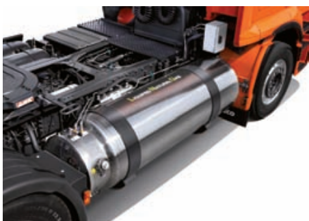
CNG biedt de mogelijkheid lange afstanden op gas te rijden. LNG heeft compactere tanks en is meer voor plaatselijk gebruik ontworpen.
